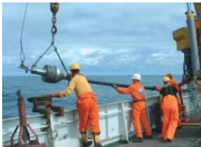
Déploiement du carottier à gravité dans le chenal des îles Féroé-Shetland lors de l'expédition NOClim à bord du navire de recherche Håkon Mosby
