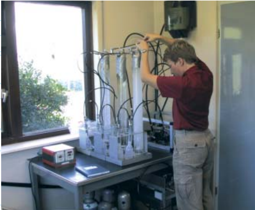
Dans la station de surveillance atmosphérique de Lutjeward (Mer du Nord), des échantillons de CO 2 sont prélevés deux fois par semaine par absorption du CO 2 dans de l'hydroxyde de sodium
