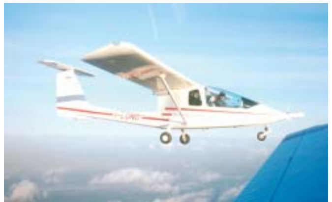
SkyArrow, le plus petit avion de recherche au monde, mesure les flux de CO 2 et de vapeur d'eau.
