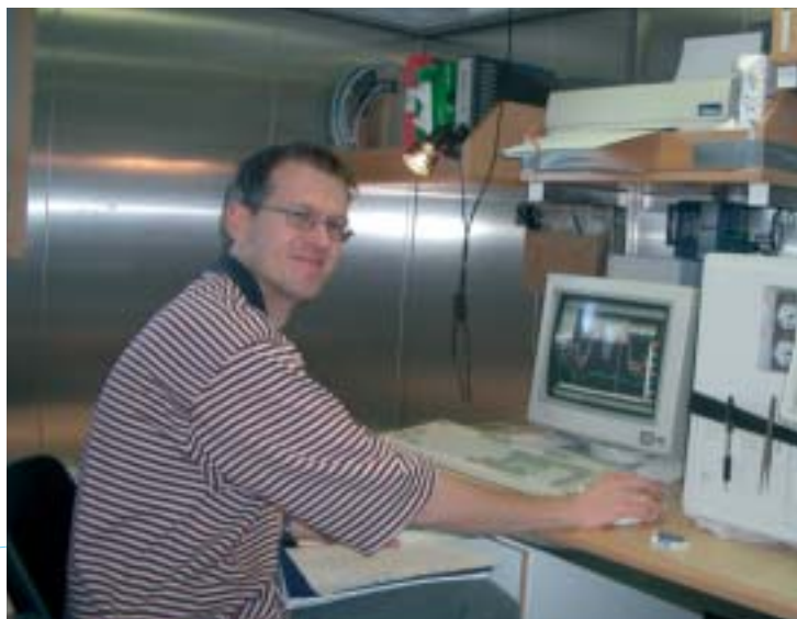
A bord du R/V G.O. Sars, Anders Olsson détermine la teneur en fréons de l'eau de mer par chromatographie gazeuse
